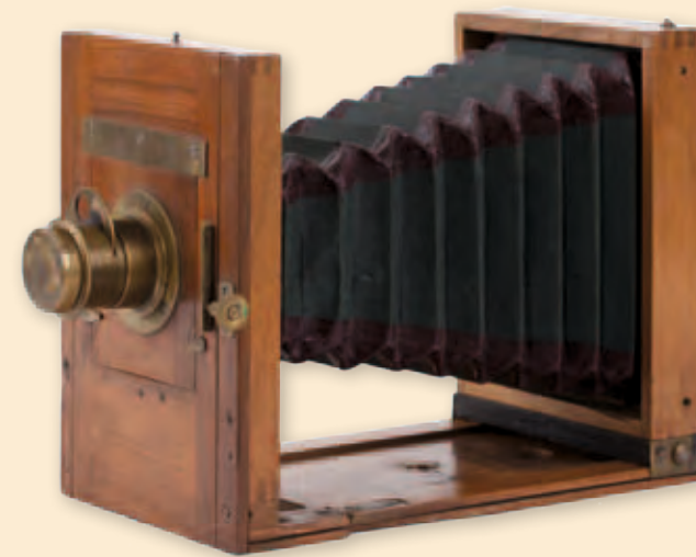
Aparat fotograficzny – mieszkowy, na płyty szklane, bez rowkowanej prowadnicy, z obiektywem nr 37724 Bistigmat 9 × 12, Rodenstock Munchen (dzisiaj właścicielem firmy Rodenstock jest korporacja Qioptic Photonics GmbH & Co. KG.), 2. poł. XIX w. metal, drewno, szkło sygn. DH 17428 OMO
