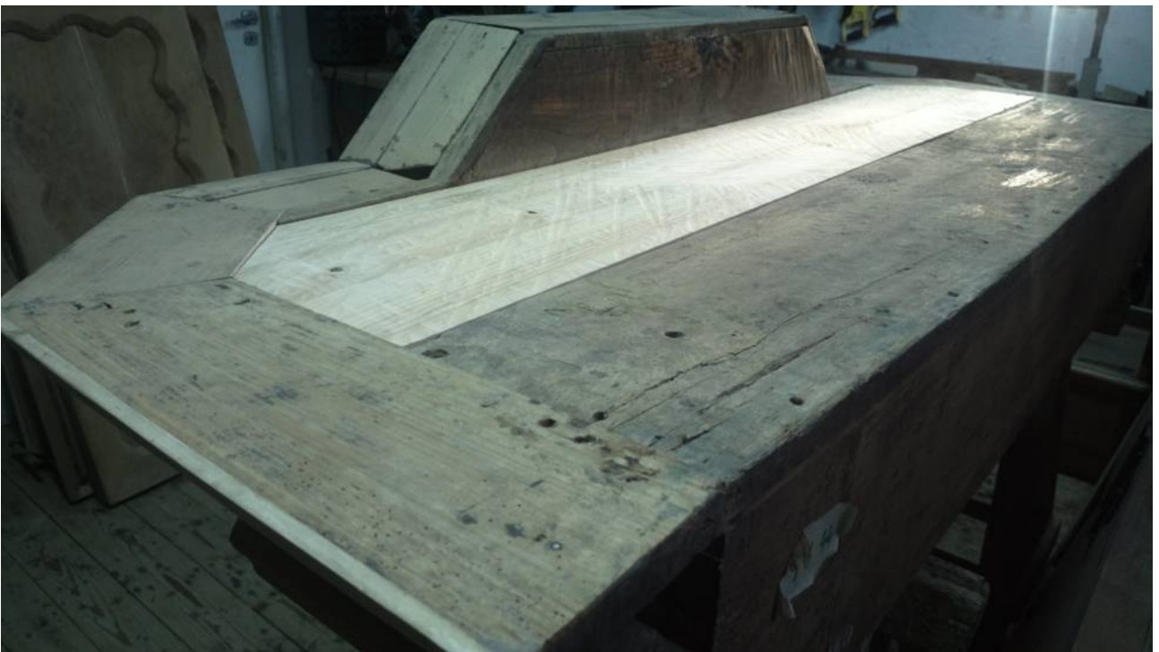
Sufit szafy , z zamontowaną deską .
