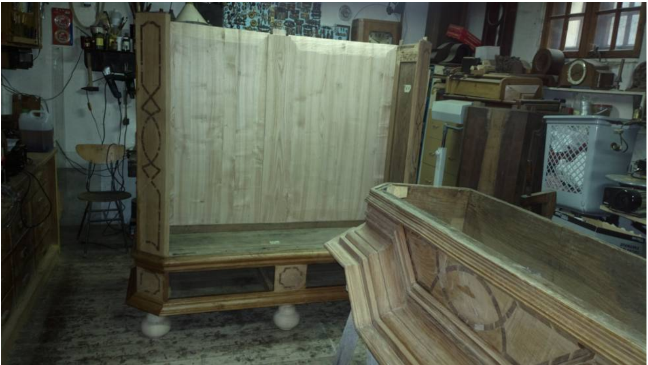
Nowe plecy i nogi wykonane , z drewna jesionowego
