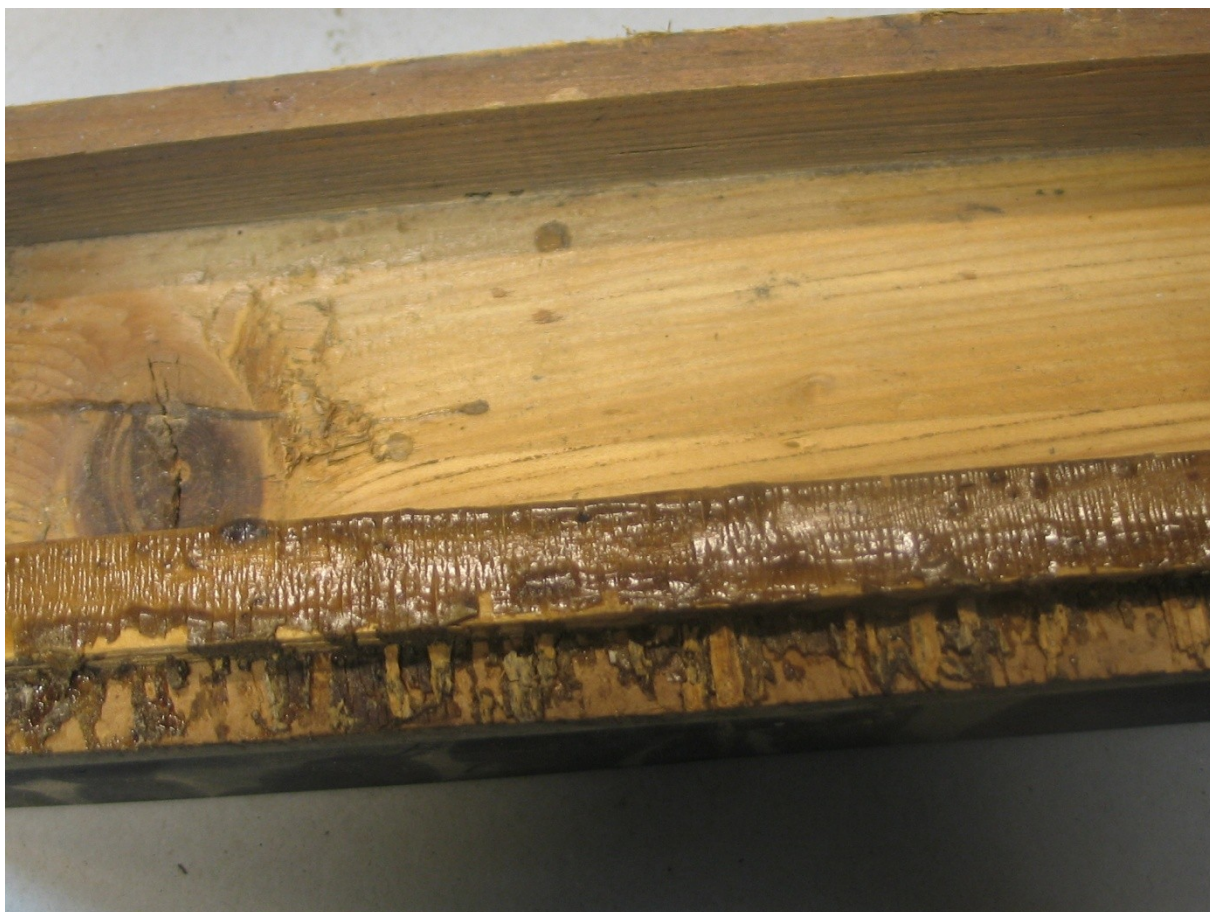
Fot.6 Podstawa kabinetu , nadmiar kleju – dwie warstwy.
