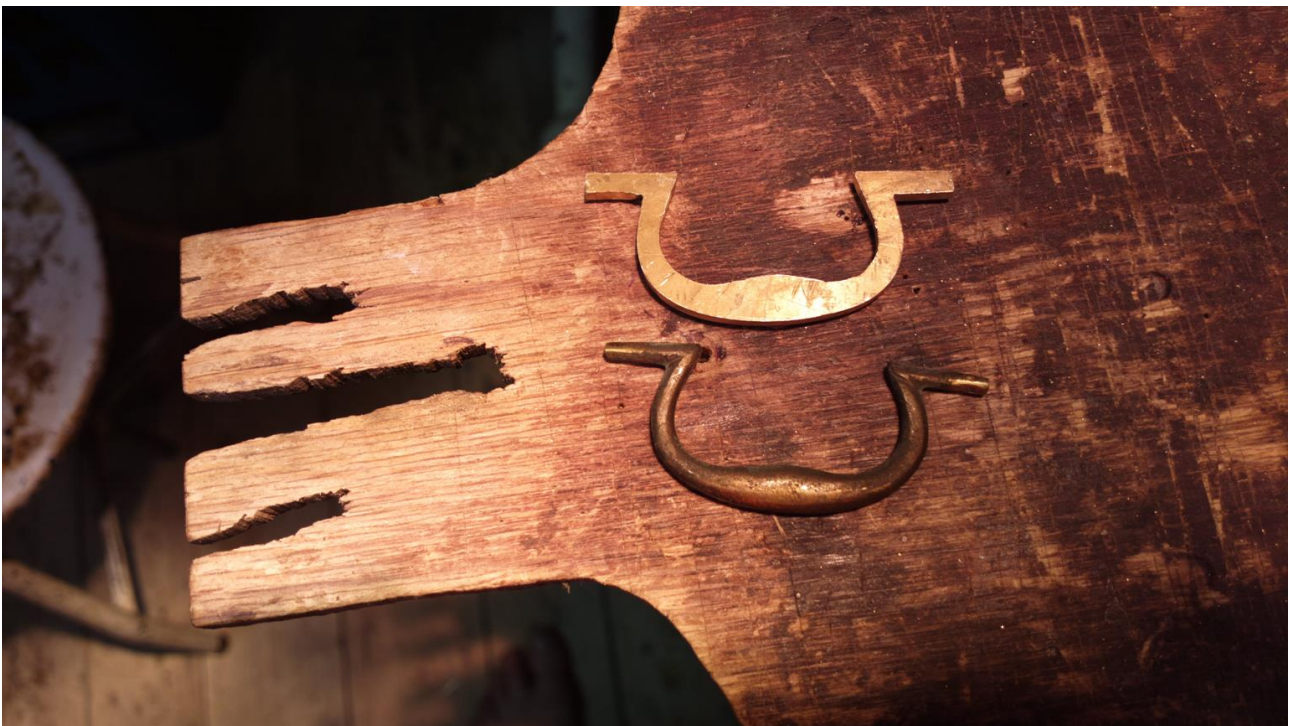
Uchwyt mosiężny wycięty z pięciomilimetrowej płyty
