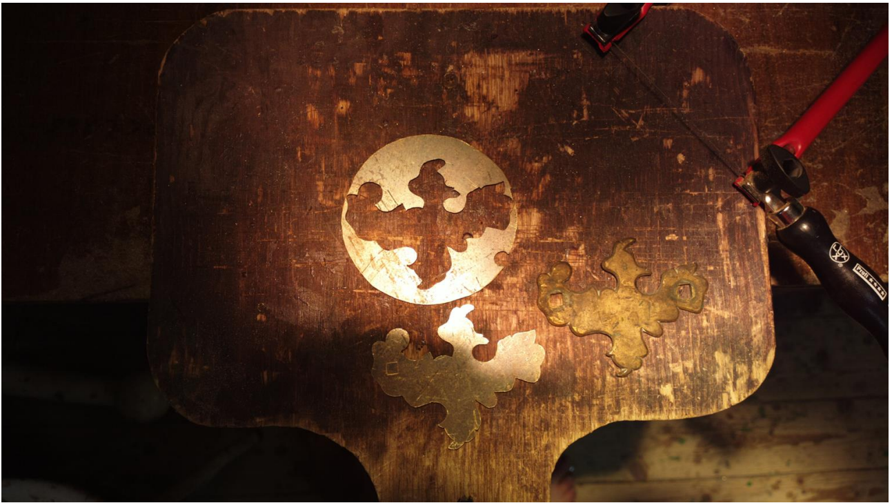
Tarczka okucia wycięta z dwumilimetrowej blachy mosiężnej .
