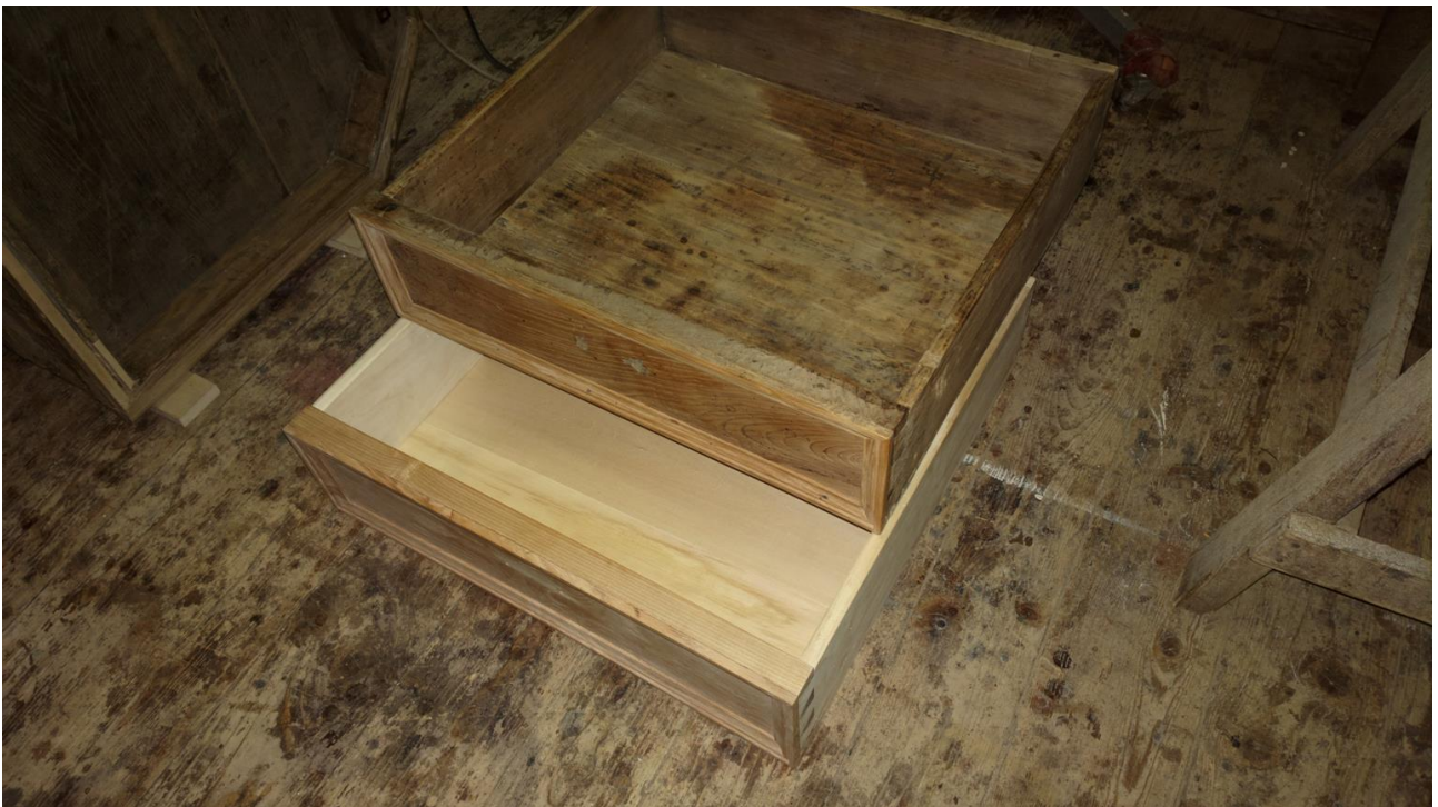
Zarówno stara szuflada, jak i nowa wykonane są z drewna lipowego i jesionowego.
