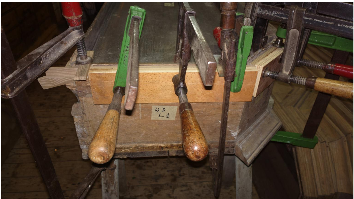
6. Flekowanie wręgów mocujących bok i plecy szafy do cokołu .
